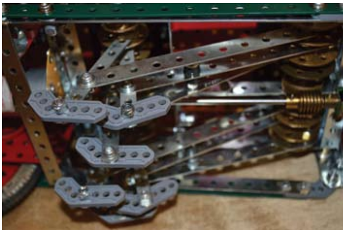
Linksboven zijn de benen te zien die voor de voortstuwing zorgen. Rechtsboven toont de het mechanisme die de benen aandrijven.
