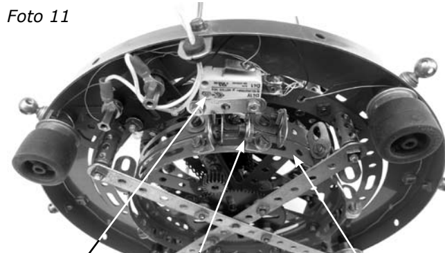
Microswitch S1 S1 in contact met fishplate Onderste hubdisc
