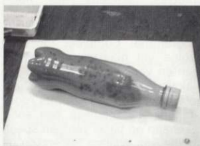
Frisdrankflesje gevuld met fijn zand, boutjes en moertjes
