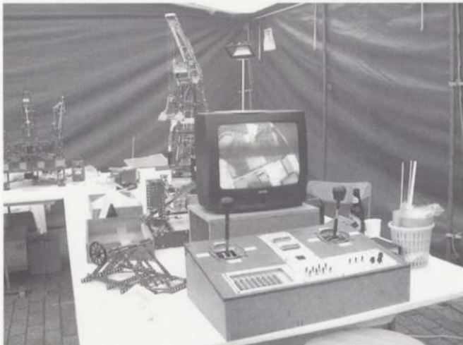
Het bedieningspaneel van de lemniskaatkraan
