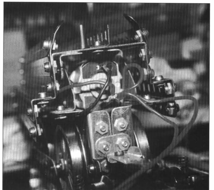
Foto 6: Draaistelchassis van de 06, blik op de motorzijde. Let op de draaispil boven de motor
