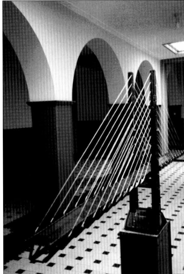
Tuibrug. Brugdek voor wegverkeer rust op balken.
