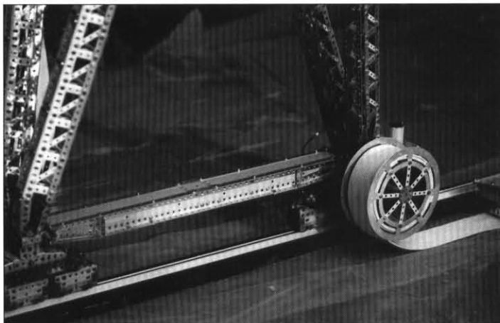
Kabel en -trommel. Rechts op de foto het 'opstijgpunt'
