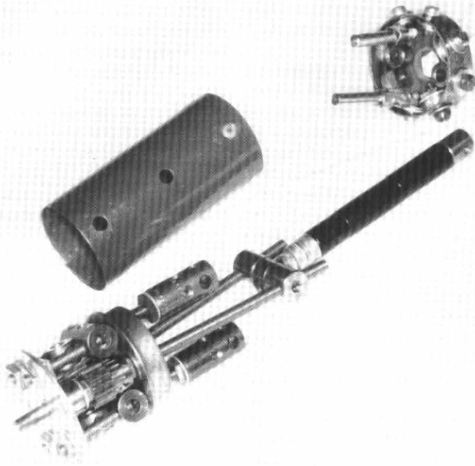
Foto 2. Binnenwerk en de cilinder die over het binnenwerk heen, tussen bovenstuk en flenswiel wordt ingeklemd.
